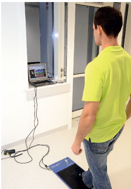
Daniel Schmidt von der Professur Bewegungswissenschaft der TU Chemnitz an einer Druckmessplatte zur plantaren Druckverteilungsmessung im Bewegungslabor des Klinikums im Standort Küchwald, in dem die Messungen durchgeführt werden sollen. Foto: Kreißig; Archiv MA/ÖA
