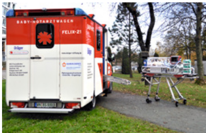
Ein spezieller, extra gedämpfter Transporter (links) und ein rollbarer Untersatz samt Inkubator – aus diesen drei Teilen besteht der Baby-Notarztwagen, der seit dem 17. November am Klinikum Chemnitz stationiert ist. Fotos: Czabania
